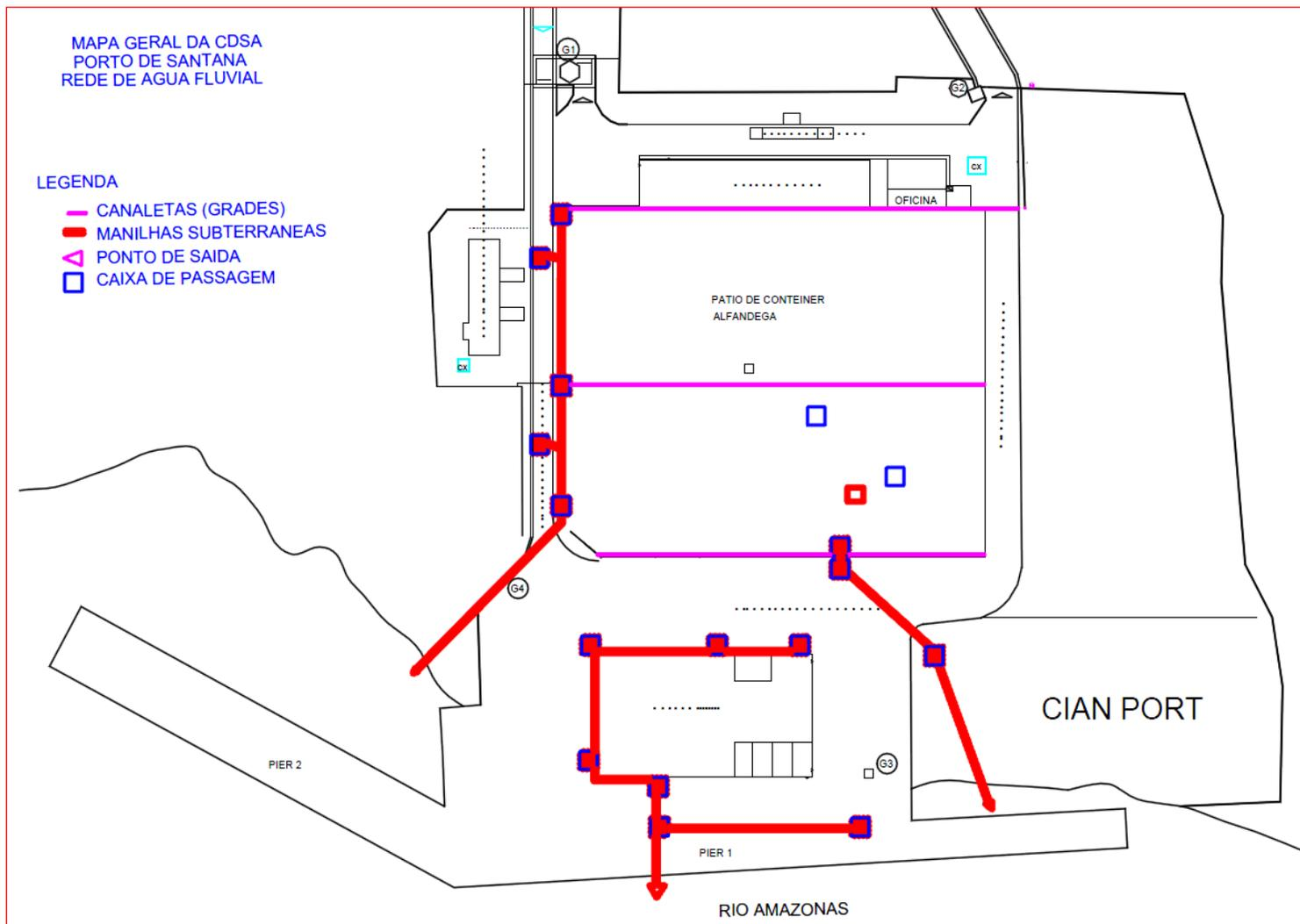
Figura 32 – Drenagem e esgoto
