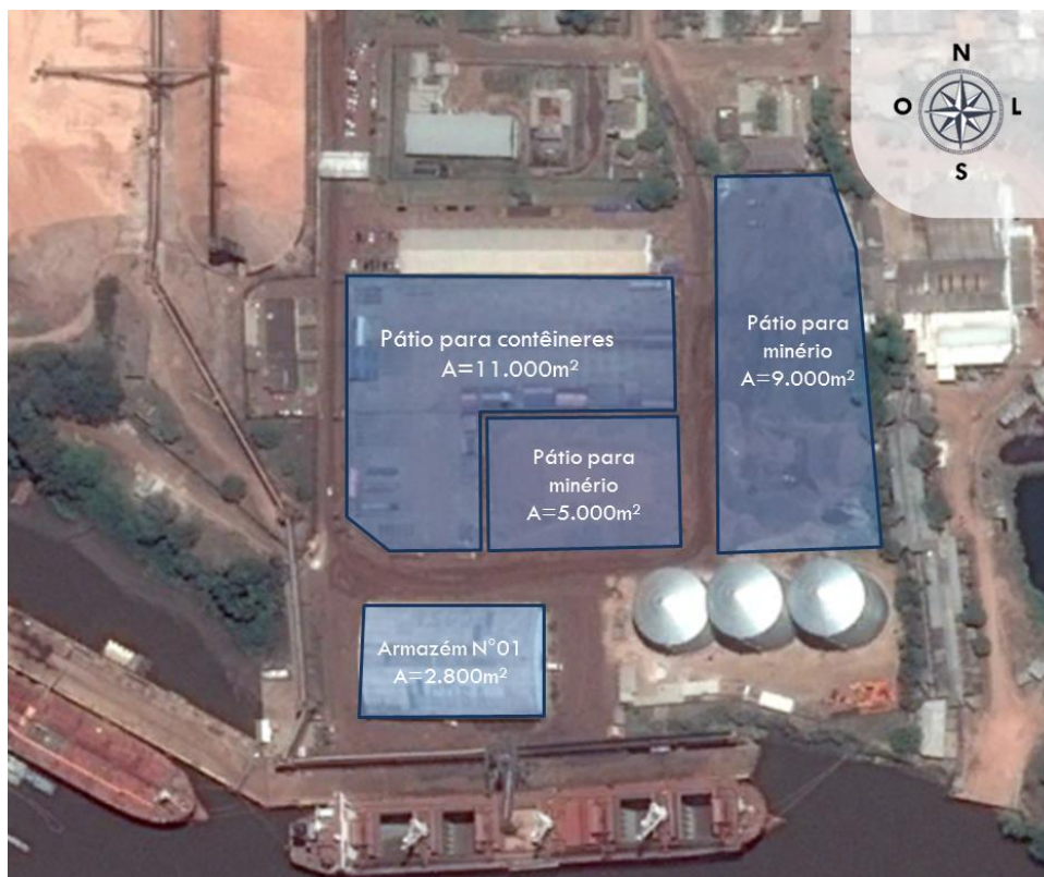
Figura 10 – Identificação das áreas remanescentes de armazenagem do porto Fonte: Administração do Porto (2014)
