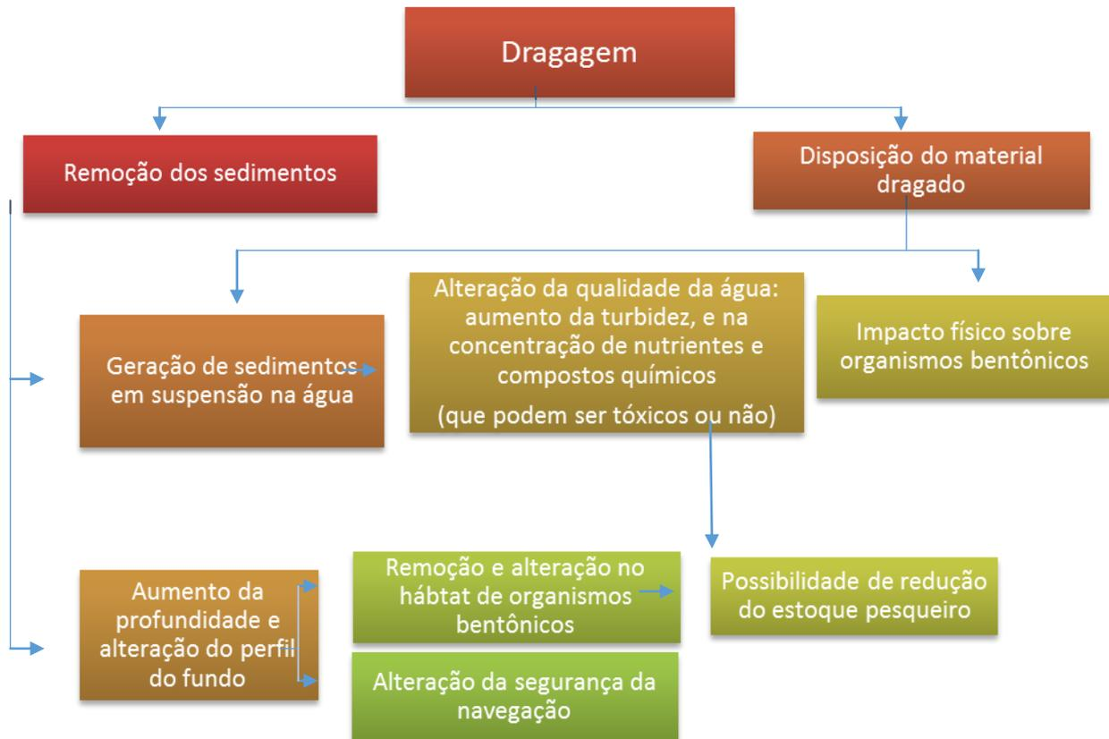
Figura 19 - Fluxograma de previsão dos Impactos da atividade de dragagem na área da CDSA.
